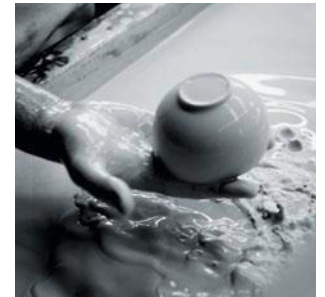
DER PORZELLANROHLING WIRD VON HAND IN DER GLASUR GEBADET.
